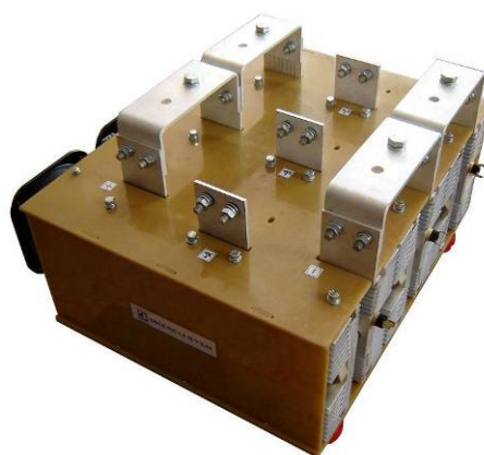
Рисунок 5 – Силовой блок выпрямителя с охлаждающей системой О153
